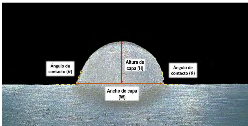
Figura 1. Macrografía representativa de las zonas de medición: ángulos de contacto, el ancho y la altura de capa.
