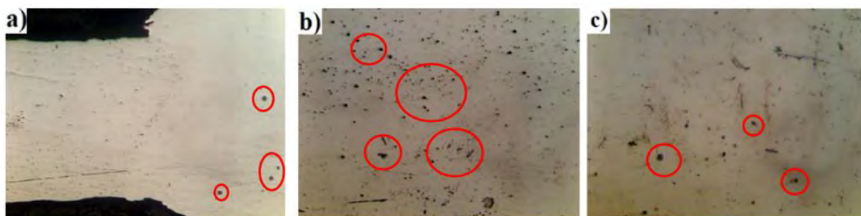
Figura 1. a) TRIP-308L ataque NaOH al 0.5mol 5x a 25°C, b) TRIP-308L ataque NaOH al 0.5mol 20x a 25°C c) TRIP-308L ataque NaOH al 0.5mol 50x a 25°C.
