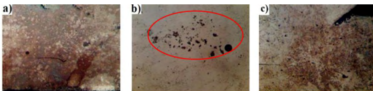
Figura 3. a) TRIP-308L ataque NaOH al 0.5mol 5x a 70°C, b) TRIP-308L ataque NaOH al 0.5mol 20x a 70°C, c) TRIP-308L ataque NaOH al 1mol 50x a 70°C.
