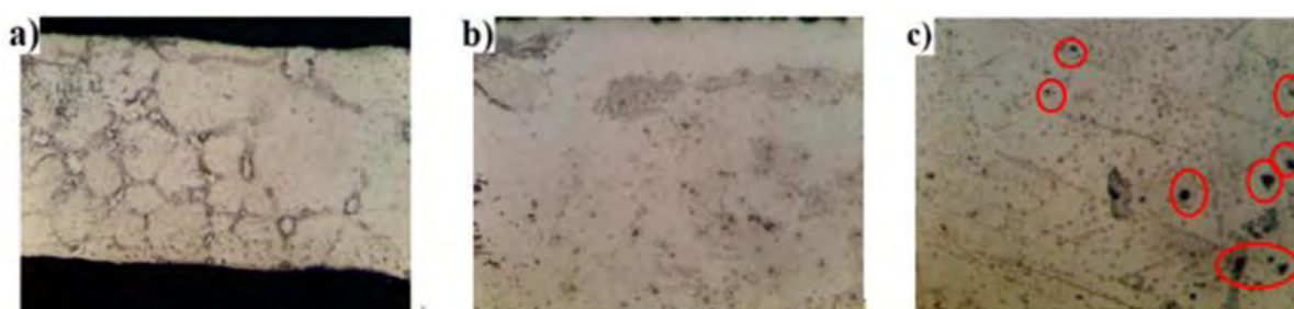
Figura 2. a) TRIP-308L ataque NaOH al 0.5mol 5x a 50°C, b) TRIP-308L ataque NaOH al 0.5mol 20x a 50°C, c) TRIP-308L ataque NaOH al 1mol 50x a 50°C.
