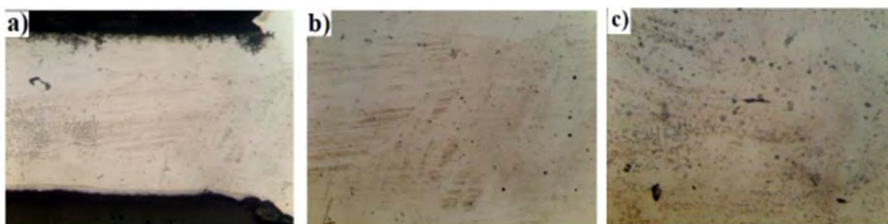
Figura 4. a) TRIP-308L ataque NaOH a 1mol 5x a 25°C, b) TRIP-308L ataque NaOH a 1mol 20x a 25°C, c) TRIP-308L ataque NaOH a 1mol 50x a 25°C.
