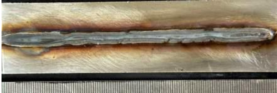
Figura 13. Cordón 11 AISI 445 realizado con RMD™ Vel. Avan. (13 mm/s) Vel. Alim. (160pulg/min) ArCL. (3).
