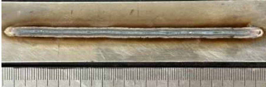
Figura 18. Cordón 16 AISI 445 realizado con RMD™ Vel. Avan. (8.33 mm/s) Vel. Alim. (160 pulg/min) ArcL. (3).
