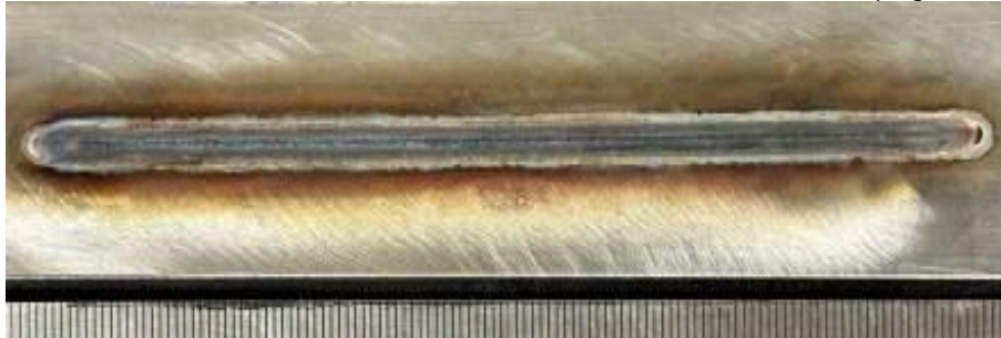
Figura 12. Cordón 10 AISI 445 realizado con RMD™ Vel. Avan. (13 mm/s) Vel. Alim. (240pulg/min) ArCL. (-3).
