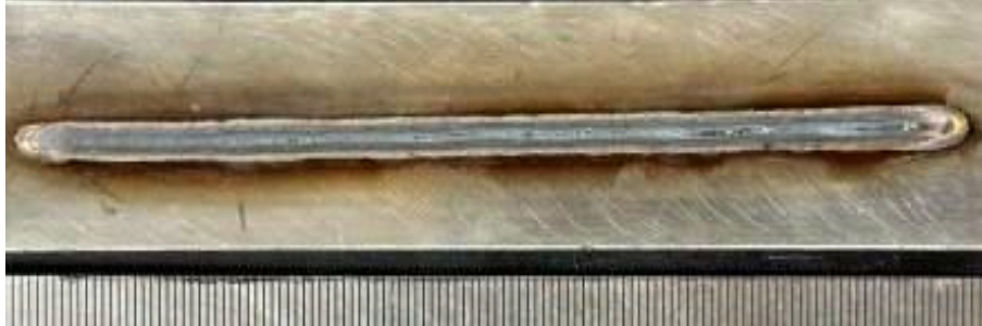
Figura 16. Cordón 14 AISI 445 realizado con RMD™ Vel. Avan. (13 mm/s) Vel. Alim. (240pulg/min) ArcL. (3).
