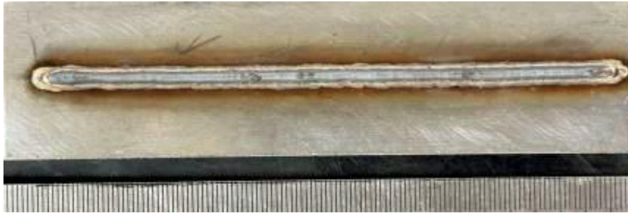
Figura 10. Cordón 8 AISI 445 realizado con RMD™ Vel. Avan. (8.33 mm/s) Vel. Alim. (240pulg/min) ArCL. (3).
