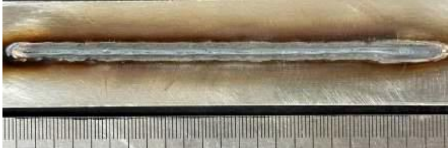
Figura 17. Cordón 15 AISI 445 realizado con RMD™ Vel. Avan. (13 mm/s) Vel. Alim. (160pulg/min) ArcL. (-3).
