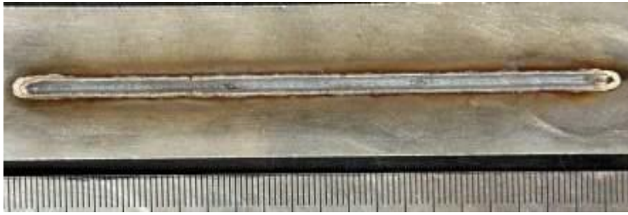
Figura 15. Cordón 13 AISI 445 realizado con RMD™ Vel. Avan. (8.33 mm/s) Vel. Alim. (240pulg/min) ArcL. (-3).
