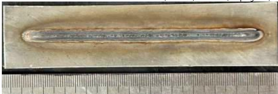
Figura 4. Cordón 2 AISI 445 realizado con RMD™ Vel. Avan. (8.33 mm/s) Vel. Alim. (240pulg/min) ArcL. (-3).
