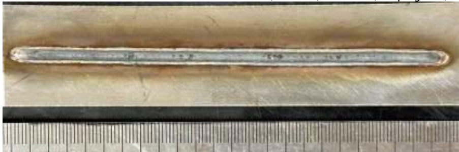
Figura 7. Cordón 5 AISI 445 realizado con RMD™ Vel. Avan. (8.33 mm/s) Vel. Alim. (160 pulg/min) ArcL. (-3).
