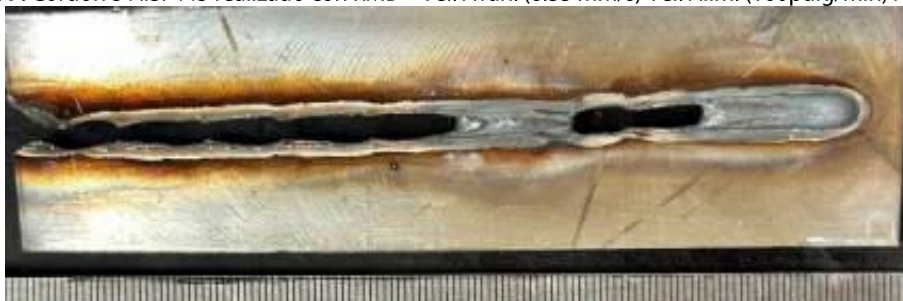
Figura 8. Cordón 6 AISI 445 realizado con RMD™ Vel. Avan. (8.33 mm/s) Vel. Alim. (240 pulg/min) ArcL. (3).
